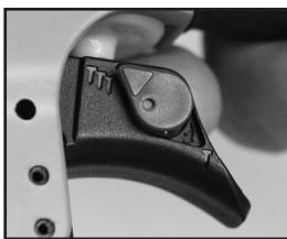
Modo de disparo de contacto (el interruptor selector de modo de disparo apunta hacia arriba)
